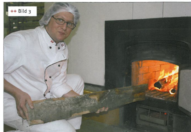
++ Bild 3 Produktionsleiter Oliver Hiestand beim Heizen des Ofens. Pro kg Teig verbraucht der Ofen 0,275 kg
